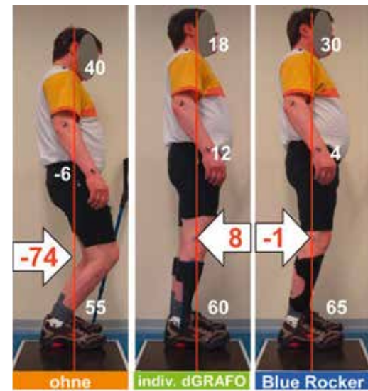
Abb. 6 Proband auf L.A.S.A.R. Posture in den drei untersuchten Situationen (die Abstandsmaße in mm sind die Mittelwerte der vier Patienten).
